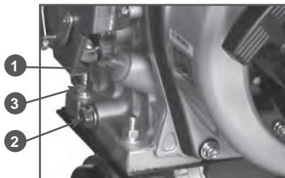
Рис. 10 Проверка уровня масла в картере
