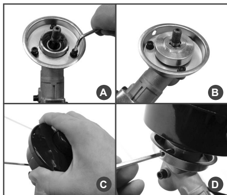
Рис.6 Установка триммерной головки
