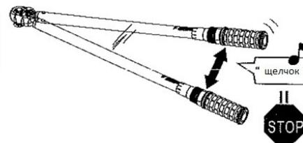
Применяйте ключ с постепенной и размеренной силой до щелчка или импульса. Не продолжайте использовать ключ после щелчка.
