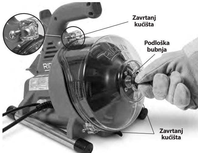
Slika 13 – Otvaranje čistača odvoda
