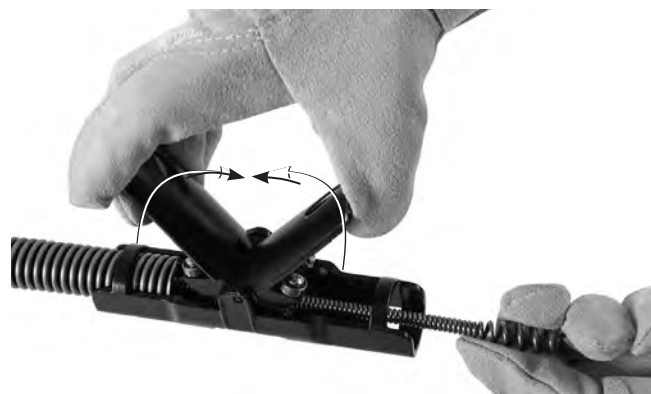
Obrázek 5 – Zavádění kabelu skrze sestavu AUTOFEED®
