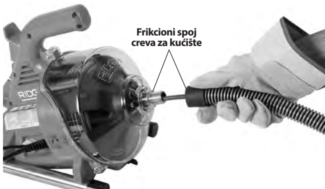
Slika 4 – Uvođenje sajle u crevo za navođenje
