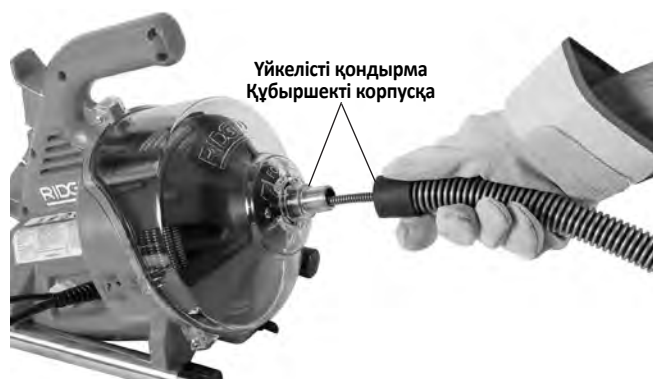
4-сурет – Кабельді бағыттауыш құбыршекке өткізу
