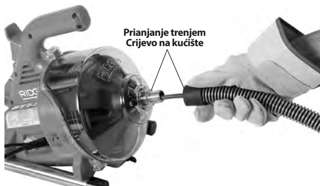
Slika 4 - Uvlačenje kabela u gibljivu cijev za vođenje
