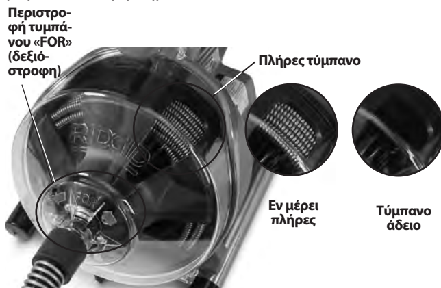
Εικόνα 10 – Παρακολούθηση του σπιράλ στο τύμπανο
