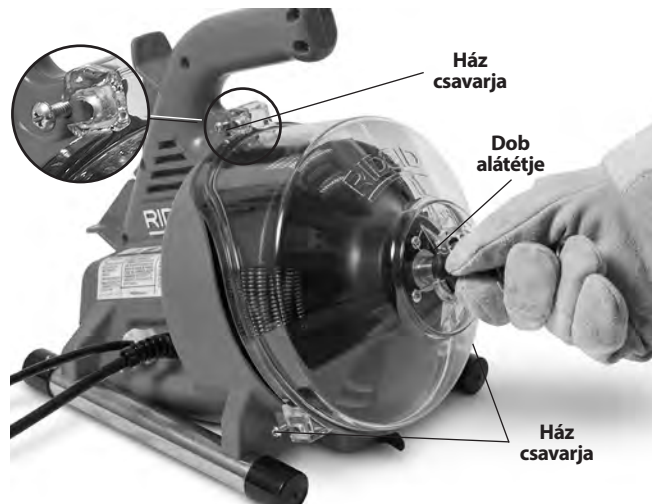
13. ábra – A lefolyótisztító gép felnyitása
