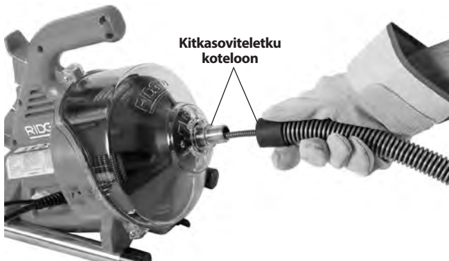
Kuva 4 – Jousen syöttäminen suojaletkun läpi
