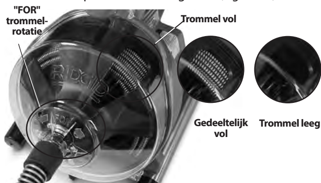
Figuur 10 - De kabel in de trommel controleren
